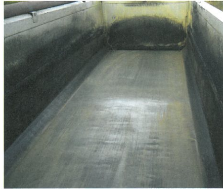
Bild 7: Leere Kippermulde nach Abladen des Michgutes für die SMA-Deckschicht mit Mexphalte RM im 1. Bauabschnitt
