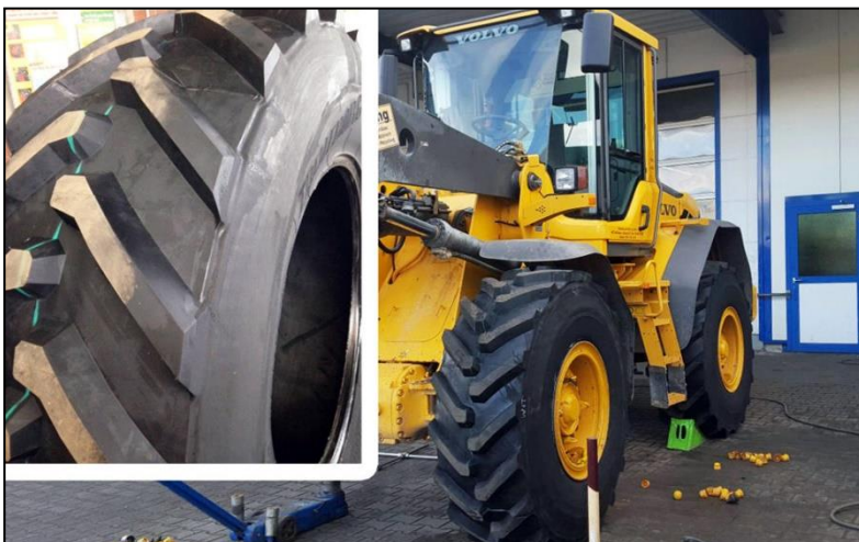
Abbildung 3: Richtig lohnenswert ist die Erneuerung von Teleskoplader- und EM-Reifen, wie z.B. 460/70 R24, 500/70 R24. Absolut einmalig ist die Möglichkeit, auch Reifen für Radlader, wie zum Beispiel 20.5 R 25 oder 23.5 R 25, mit Ackerschlepperstollen auszurüsten. Bild: Hofmann Runderneuerungstechnik GmbH®.
