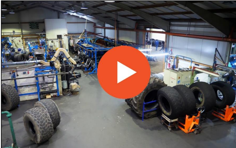
Abbildung 2: Hofmann investiert regelmäßig in die Verbesserung seiner Produkte. Sämtliche Karkassen werden vor der Runderneuerung gründlich überprüft und in einer Shearographie-Anlage auf Separationen unterhalb der Lauffläche untersucht. Sehen Sie sich das Video dazu an. Bild/Video: Hofmann Runderneuerungstechnik GmbH®.
