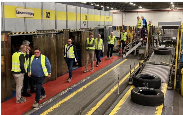
Abbildung 2: 400 Mitarbeiter fertigen in Homburg pro Jahr bis zu 620.000 runderneuerte Lkw-Reifen auf Basis qualitativ hochwertiger Michelin-Karkassen. Derzeit können bis zu 90 Prozent der Michelin-Karkassen der Runderneuerung zugeführt werden.
