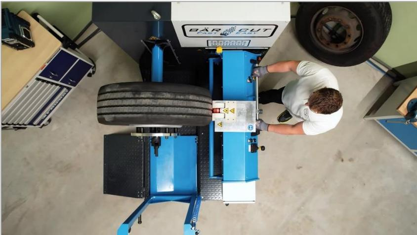
Die halbautomatische Bear-Cut Maschine von AZuR-Neupartner [Bear-Machines](#) ermöglicht das schnelle, leichte und effiziente Nachschneiden von Nutzfahrzeugreifen mit dem Label REGROOVABLE. Mit der Nachprofilierung wird der Lebenszyklus des Nfz-Reifens um bis zu 25% verlängert. Nachgeschnittene Nutzfahrzeugreifen ersparen den Einkauf von Neureifen und verbrauchen zudem weniger Kraftstoff.
