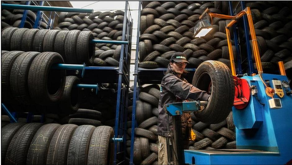
Zur Überprüfung der Tauglichkeit gebrauchter Lkw-Reifen für die Runderneuerung werden die Karkassen der Reifen einer strengen Kontrolle unterzogen – mit Shearografie, Röntgentechnik und einem visuellen Check. Denn runderneuerte Markenreifen müssen dieselben strengen Qualitätsanforderungen erfüllen wie Neureifen und werden in der Regel nach den Konstruktionsdaten von Neureifen gefertigt. Bild: AZuR.
