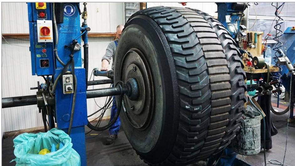
Runderneuerte Nfz-Reifen werden für fast alle Fahrzeugarten und Einsatzbereiche hergestellt. Sie werden nach den Konstruktionsdaten von Neureifen gefertigt, durchlaufen zahlreiche Sicherheits- und Qualitätskontrollen und erfüllen die hohen Anforderungen der ECE R109 für Nfz-Reifen. Die Laufflächenprofile runderneuerter Nfz-Reifen entsprechen denen von Neureifen. Bild: Hofmann Runderneuerungstechnik.
