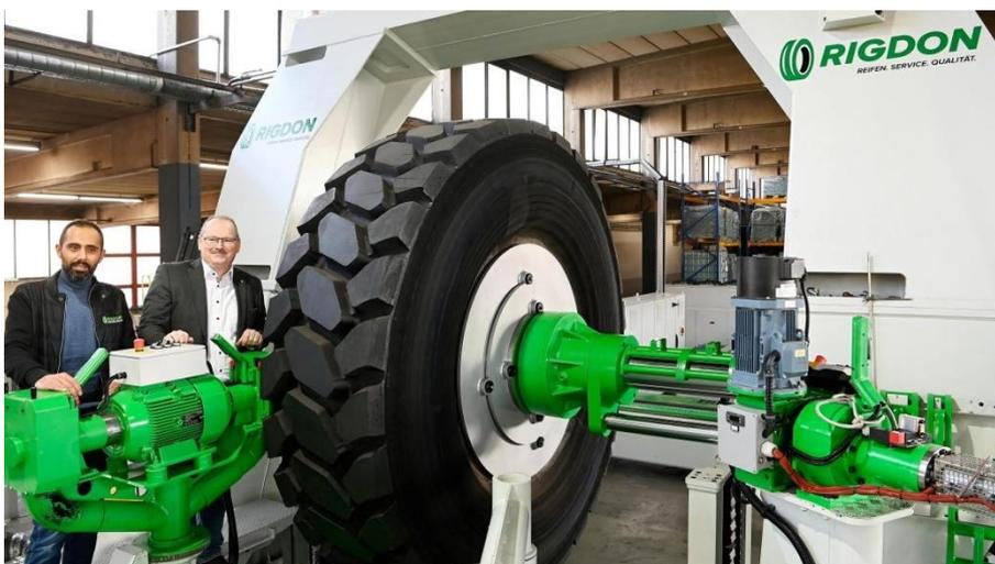
Der Günzburger Reifenhersteller Rigdon investiert einen zweistelligen Millionenbetrag in die Modernisierung seines Runderneuerungswerks. Im Werk steht u.a. eine neue, deutschlandweit einzigartige Riesenmaschine für die Runderneuerung tonnenschwerer Reifen für Muldenkipper, mit einem Durchmesser von knapp drei Metern und einer Profiltiefe von acht Zentimetern. Bild: RIGDON®.
