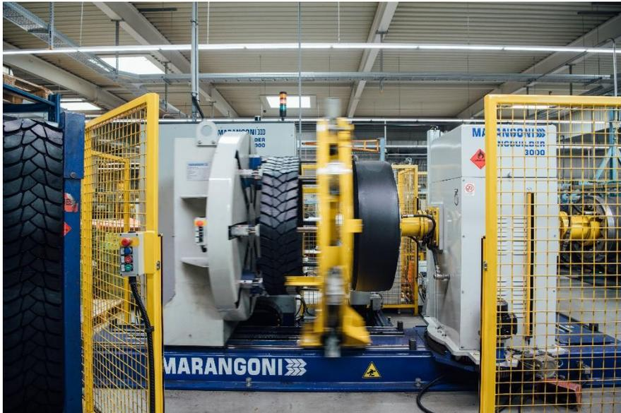
Mit dem innovativen RINGTREAD-Runderneuerungssystem von Marangoni werden vorgefertigte, nahtlose Laufflächenringe auf die Karkassen gebrauchter Reifen aufgebracht. Die RINGTREAD-Lauffläche liegt perfekt auf der Karkasse und der runderneuerte Reifen ist nahezu vibrationsfrei. Er erhält somit eine ausgezeichnete Laufeigenschaft und nicht zuletzt eine beeindruckende Optik. Bild: MARANGONI
