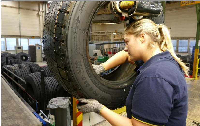
Bild 2: In Europa runderneuerte Reifen durchlaufen zahlreiche Sicherheits- und Qualitätskontrollen und erfüllen die hohen Anforderungen der ECE R108/109. Die Profilvarianten decken alle typischen Nfz-Einsatzbereiche und Achspositionen ab. Bildquelle: Michelin.
