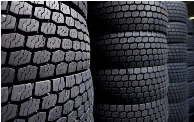
Bild 3: Mit modernster Technologie werden nur die Laufflächen und Seitenwände abgefahrener Markenreifen erneuert. Dadurch können in Europa jährlich Millionen Tonnen Abfälle vermieden und natürliche Ressourcen geschont werden. Bildquelle: RuLa.
