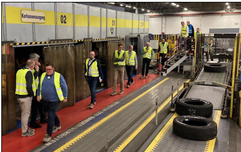
Bild 4: Rund 400 Mitarbeiter fertigen in Homburg pro Jahr bis zu 620.000 runderneuerte Lkw-Reifen auf Basis qualitativ hochwertiger Michelin-Karkassen. Derzeit können bis zu 90 Prozent der Michelin-Karkassen der Runderneuerung zugeführt werden. Bildquelle: AZuR.
