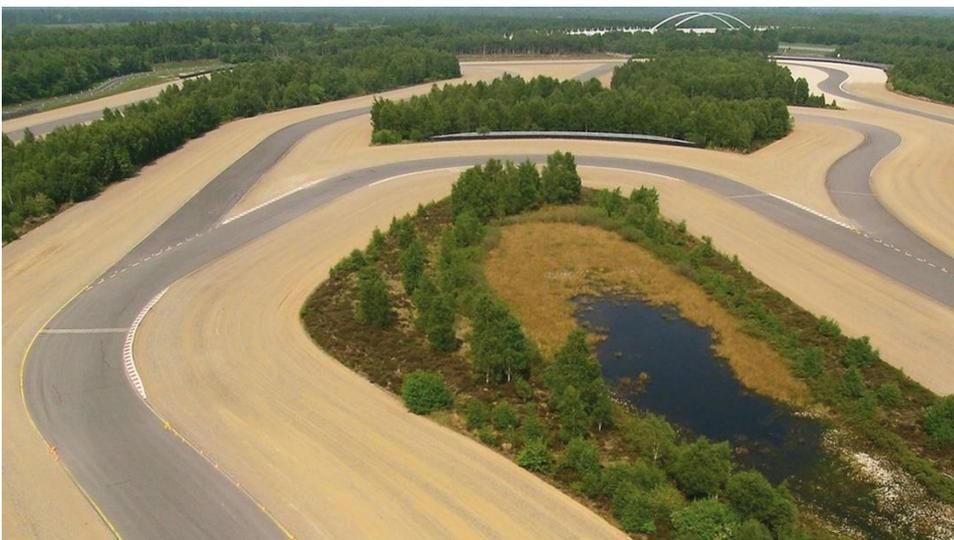
Für die Entwicklung von Reifen mit bestmöglichen Eigenschaften in punkto Haftung, Rollwiderstand, Geräuschentwicklung und Sicherheit, werden von Sumitomo in Kooperation mit den Fahrzeugherstellern spezielle Teststrecken betrieben. Hier werden Neureifen im Fahrverhalten und bei Nässe optimiert, sowie auf unserem eigenen Testgelände in Schweden im Schnee und Eis auf Herz und Nieren geprüft. Bild: ATP Papenburg.
